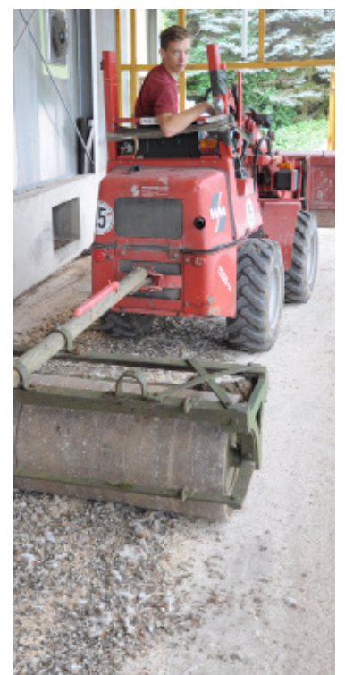
Das Gemisch aus Legehennenkot und zerkleinerten Eierschalen wird getrocknet und gewalzt.
